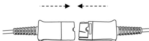
Conecte o conector RJ09 do Cabo Espiral no terminal telefônico a ser utilizado;
